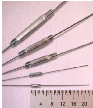
磁性干簧开关，玻璃体仅 3.7mm，几乎适用所有场合
