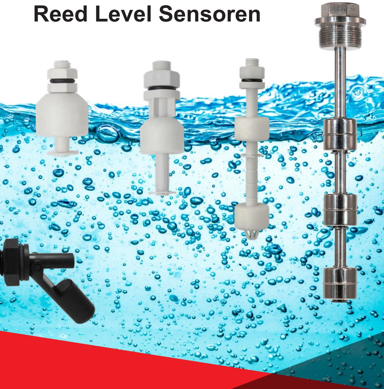
Reed Level Sensoren erfassen Pegeländerungen in Flüssigkeiten. Die Sensoren bestehen normalerweise aus einem Schwimmer mit einem eingebauten Magneten, welcher sich entlang eines Schafts auf und ab bewegt. In diesem Schaft ist der Reed Schalter verbaut, welcher bei Annäherung an das Magnetfeld aktiviert wird. Dadurch wird eine Veränderung des Flüssigkeitslevels signalisiert.
