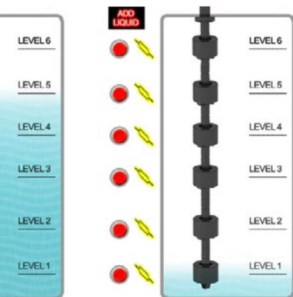
Unsere Produkte sind dabei als separate Komponenten, als einzelne Baugruppe mit verschiedenen Elementen oder als finales Produkt mit integriertem Level Sensor, erhältlich. Dies vereinfacht einerseits die Installation und reduziert andererseits die Kosten.
